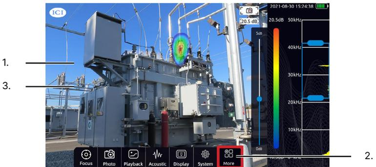
**THE USER SHOULD ENSURE THE PROPER MODE IS CHOSEN FOR THE USE APPLICATION. GAS LEAK MODE IS FOR FINDING COMPRESSED AIR LEAKS. PARTIAL DISCHARGE MODE IS FOR FINDING VOLTAGE PARTIAL DISCHARGES.**
